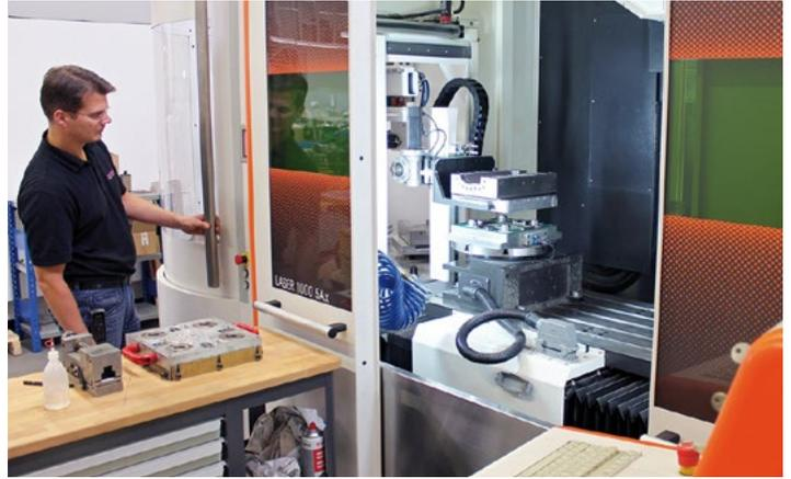
**Automatisierung (6-fach-Palettenwechsler) an einer Laseranlage für rationelle Fertigung** Foto: Reichle
