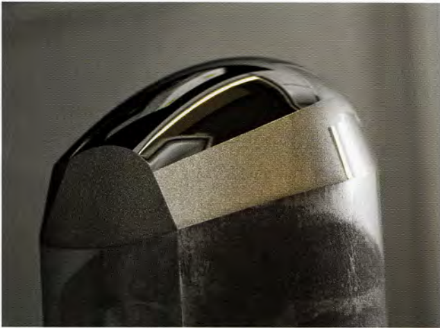
Gelasserte Erodierstruktur mit präziser Abgrenzung zur Hochglanzpolitur
