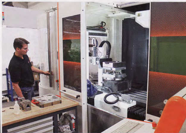
Automatisierung (6-fach-Palettenwechsler) an einer Laseranlage für rationelle Fertigung
