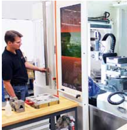
Die AgieCharmilles Laser 1000 5Ax ist bei Reichle mit einem 6-fach-Palettenwechsler ausgestattet.
