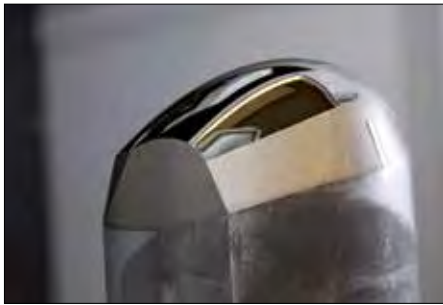
Gelasserte Erodierstruktur (ERO30) mit präziser Abgrenzung zur Hochglanzpolitur.
