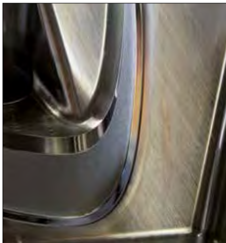
Gelasserte Ätznarbung (K2400G) mit scharfer Abgrenzung zu Hochglanzflächen ohne Prozessrisiko.
