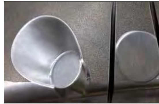
Lasertexturierung eines Druckgusswerkzeugs mit einer Ätznarbung (K85).
