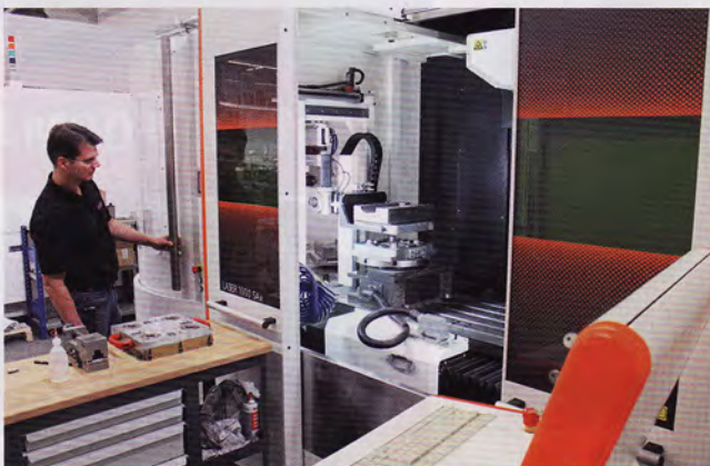
Bild 2: Automatisierung (6-fach Paletten- wechsler) an einer Laseranlage für rationelle Fertigung
