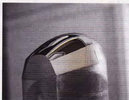
Bild 5: Gelaserte Erodierstruktur (ERO30) mit präziser Abgrenzung zur Hochglanzpolitur
