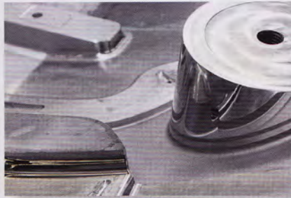
Bild 4: Gelaserte Ätznarbung (Feinnarbe L), Fläche und Ring auf hochglanzpolierter Freiformfläche inkl. partieller Narbtiefenreduzierung
