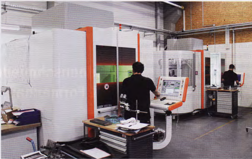
Bild 1: 2 von 4 Laseranlagen (5-Achs) für alle Narbungen und Texturen
