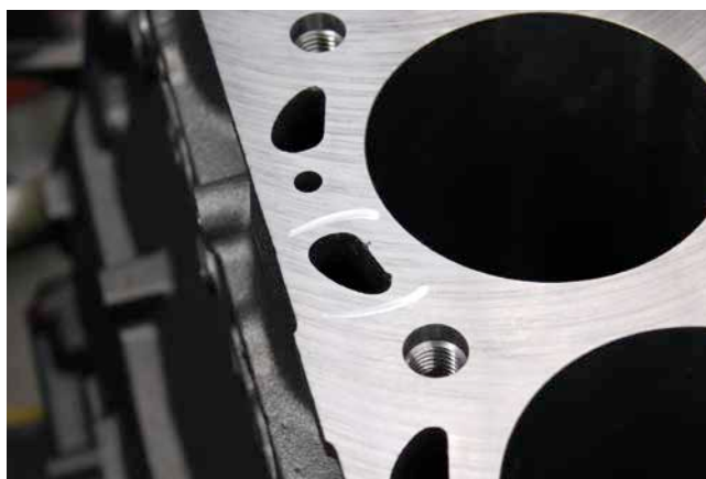
Bild 2: Nacharbeit des Schweißguts durch speziell ausgebildete Oberflächentechniker an einem 6-Zylinder-Lkw-Kurbelgehäuse.
