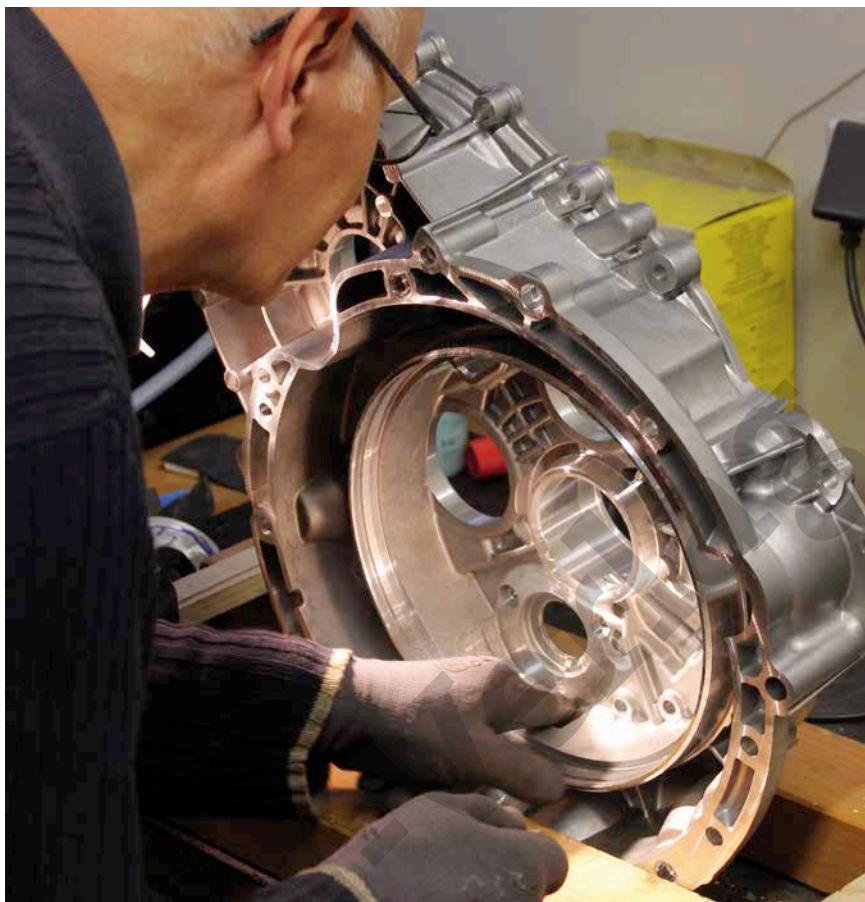
Bild 4: Qualitätsprüfung und Nacharbeit des Laserschweißens als elementarer Bestandteil der Gussteileinstandsetzung bei Reichle an einem Pkw-Kupplungsgehäuse.
